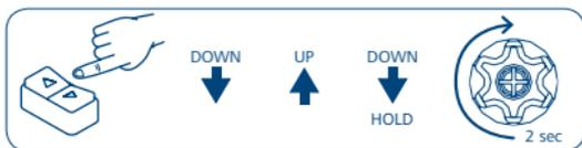
Appuyer sur les boutons comme indiqué en séquence rapide et rester appuyé sur le bouton indiqué par « HOLD », afin de vérifier le mouvement de confirmation du moteur.
