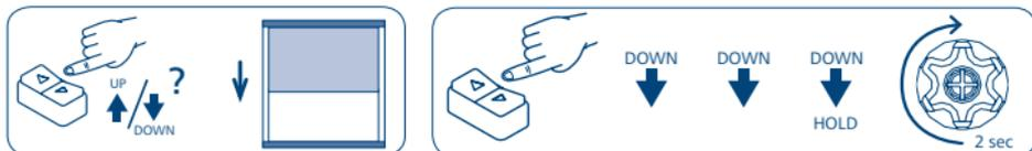
À l'aide du bouton de montée, faire remonter le store jusqu'à la position souhaitée (pour les stores coffres, il faudra maintenir la touche pressée jusqu'à ce que le moteur s'arrête automatiquement à l'arrivée en butée).
